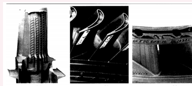
FIGUUR 5.12 Koelkanalen in de schoepen van een gasturbine (bron: General Electric) (a) looppoort; (b) deel van looppoort; (c) deel van straalbuisring
