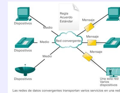
Los avances en la tecnología nos permiten consolidar estos tipos de redes diferentes en una plataforma conocida como "red convergente", que es la capacidad de transmitir datos, voz y video por la misma infraestructura de red.
