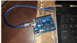
Cuando el circuito se encuentre conectado completamente (como se mostró en el Paso 4) se debe alimentar la placa de Arduino UNO mediante un puerto USB de la computadora o algún otro método compatible con este mismo.
